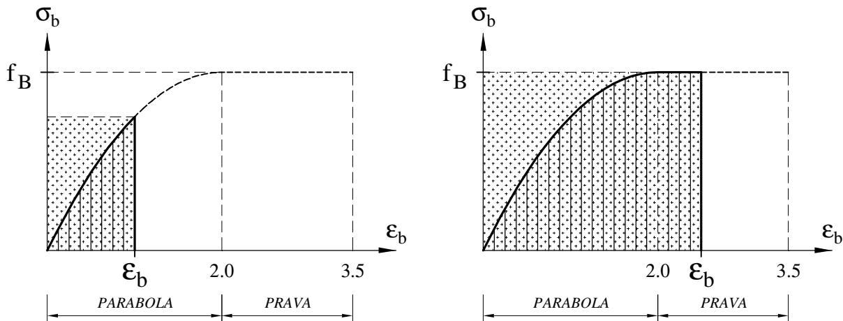
$f_B$  - računska čvrstoća betona pri pritisku. U zavisnosti od marke betona, a za Pravilnikom definisani računski dijagram betona u obliku parabola+pravougaonik, uzima vrednosti iz tabele (član 82. Pravilnika BAB 87):
